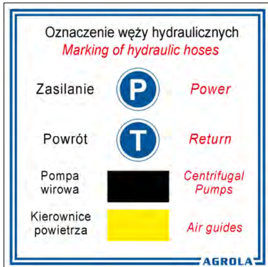
Rys. 42. Oznaczenie węży hydraulicznych – piktogram (P41)
